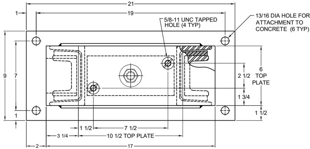
**MODEL M2SSH-2F 2- SPRING SEISMIC ISOLATORS FOR NOMINAL 2" DEFLECTION**
